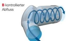
Der bei ansteigendem Wasserstand anspringende Wirbel sorgt für einen nahezu konstanten Abfluss
