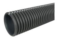
Teilsicker-, Vollsicker- und Mehrzweckrohre aus PE-HD nach DIN 4262-1, Typ R2, Wassereintrittsfläche  $\geq 50~\text{cm}^2/\text{m}$  für LP, TP, MP, Schlitzbreite 1,2 mm  $\pm$  0,4 mm. Entsprechend RAS-Ew (Richtlinien für die Anlage von Straßen, Teil: Entwässerung) einsetzbar (SN 4 nach DIN EN ISO 9969). Rohr-Sonderfertigungen auf Anfrage lieferbar.
