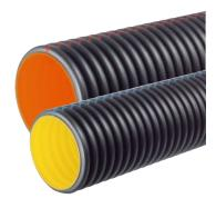
Kanalrohr aus PP mit profilierter Wandung und glatter Rohrinnenfläche gemäß DIN EN 13476. Ringsteifigkeitsklasse SN 8 oder SN 16 nach DIN EN ISO 9969. Gelbes (SN 8) bzw. oranges (SN 16) Innenrohr, schwarzes Außenrohr, homogen verschweißt. Mit einextrudiertem roten und blauen Streifen. Innenrohr bei SN 16 mit einer Mindestwanddicke von 3,5 mm gemäß Anforderung DWA-A 142 TWZ II+III.
