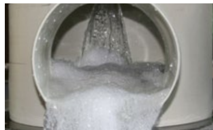
Afvoer uit het verwisselbare restrictiedeksel
